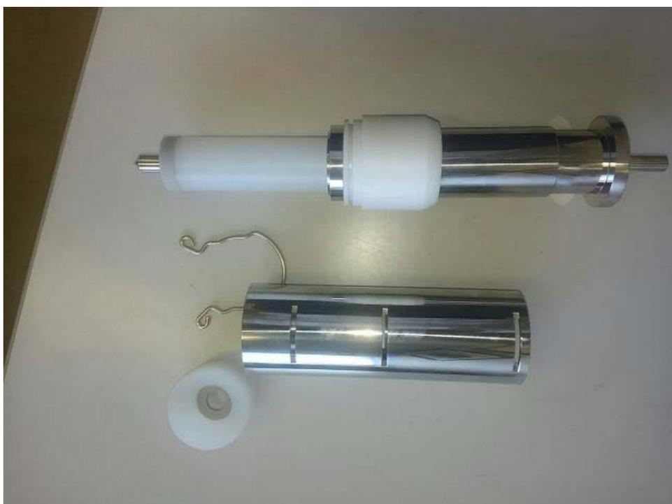
(5) エアパイプ止め（図面5）を外します、これによってエアパイプ下（図面8）が取り外せます
