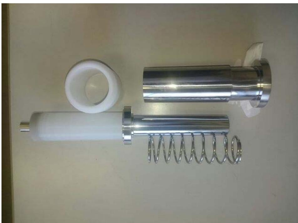
(7) ピストンからピストンパイプ (図面 1 3) を抜きピストンパイプについている入り味調整カラー (図面 1 5) とシールパッキン (図面 1 6) を外します
