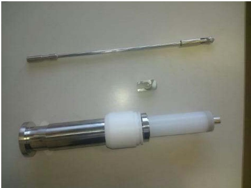
(6) 本体（図面7）からピストン（図面9）を抜きます、これにより本体、ピストン、スプリング（図面11）ガイド上（図面12）が分解できます
