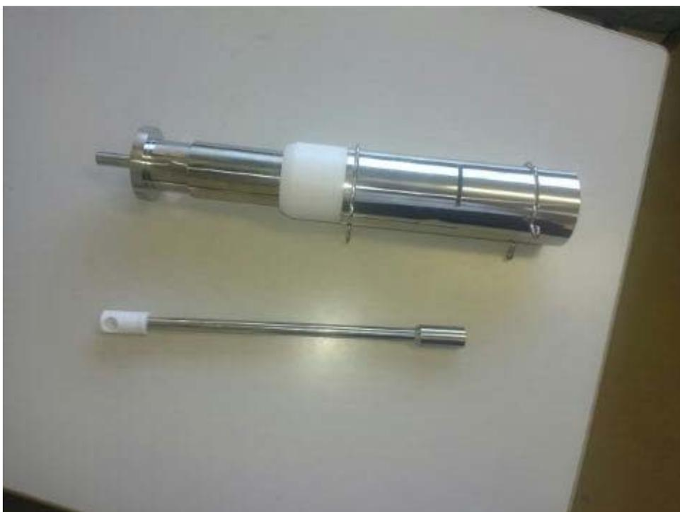
(3) 止めピン (図面 20) の上側を外します、これによってガイド下 (図面 17) スプリング (図面 19) が取り外せます
