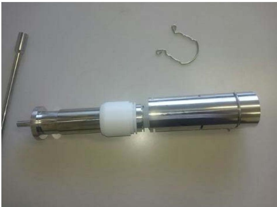
(4) ガイド下の止めピンの下側を外します、これによってアタッチメント (図面 21) が取り外せます
