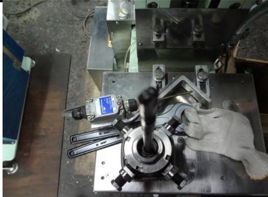
2、中央の瓶押さえが回ると天面穴に棒が通らなくなるので固定した状態で左回転で回してください。
