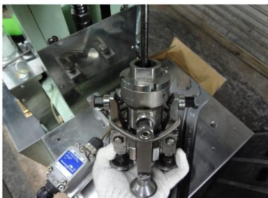
4、ねじから外れると落下しますので、テーブルの上で落とさないようしっかり手で支えてください。
