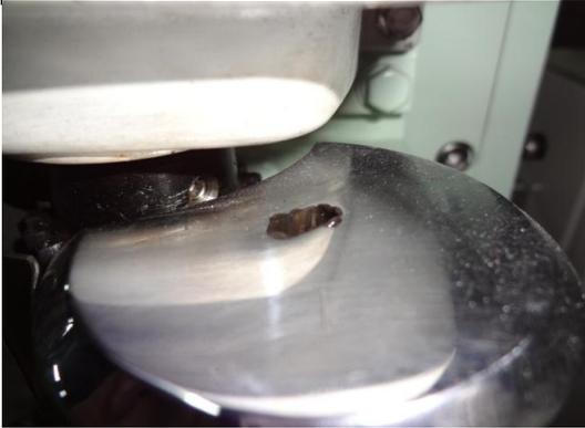
1、ギアボックス天面の穴とチャック棒の方向が同じになるようにしてから挿入してください。
