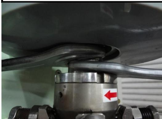
1、樹脂カバーを外し、付属しているスパナを写真のように差し込みます。
