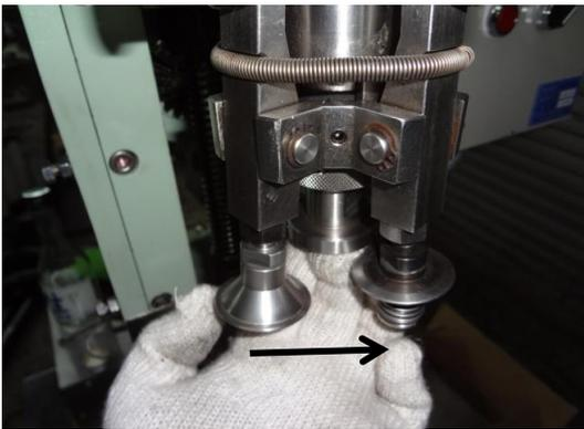
3、ねじがかかった後スパナに持ち替え、上部を固定しながらチャックを回します。回してる途中で硬くなった場合はチャック棒が天面穴と違う方向を向いてしまっているので、もう一度やり直してください。
