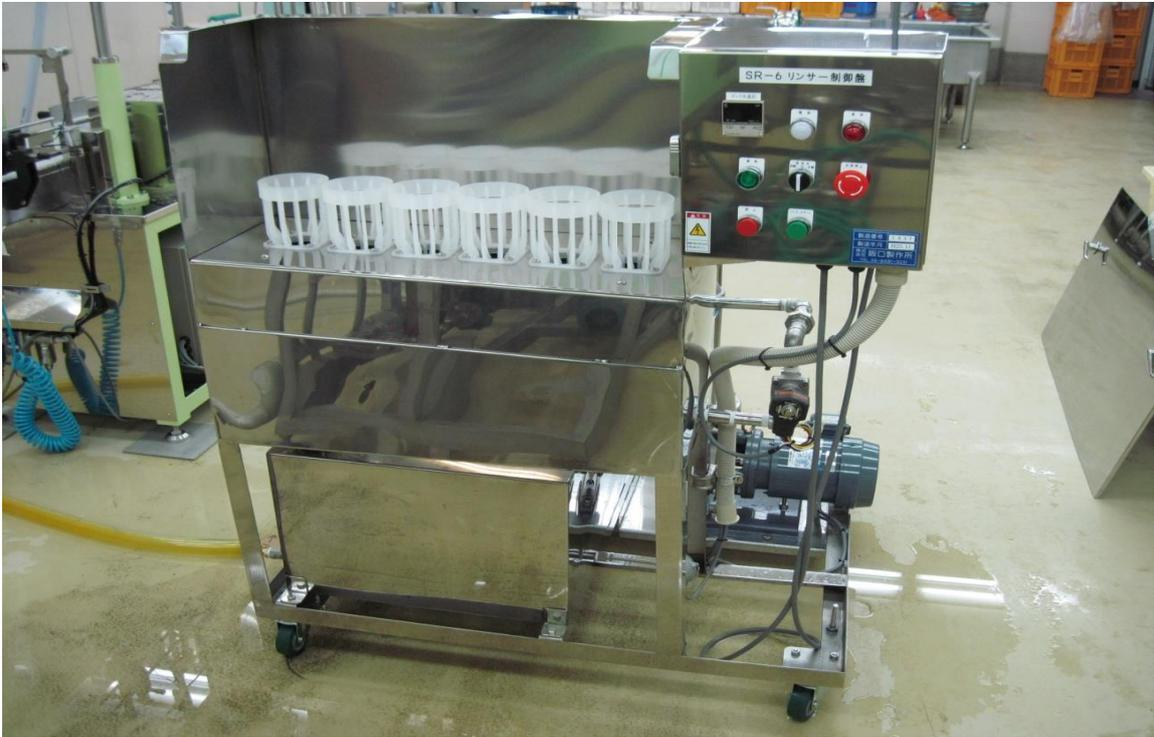
SRリンサーは手入れ手出しで行うボトルリンサーです。
