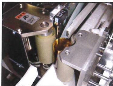
3本ローラーでボトルを回転させラベリングします。
